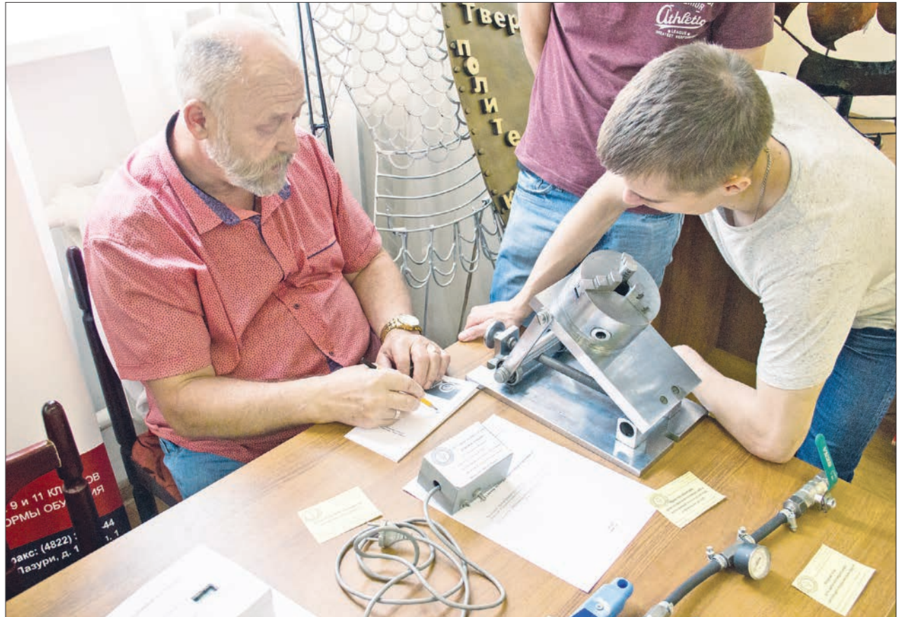
С помощью этого прибора можно сверлить отверстия под любым углом. ФОТО: АНТОН ЯРОШИНСКИЙ
