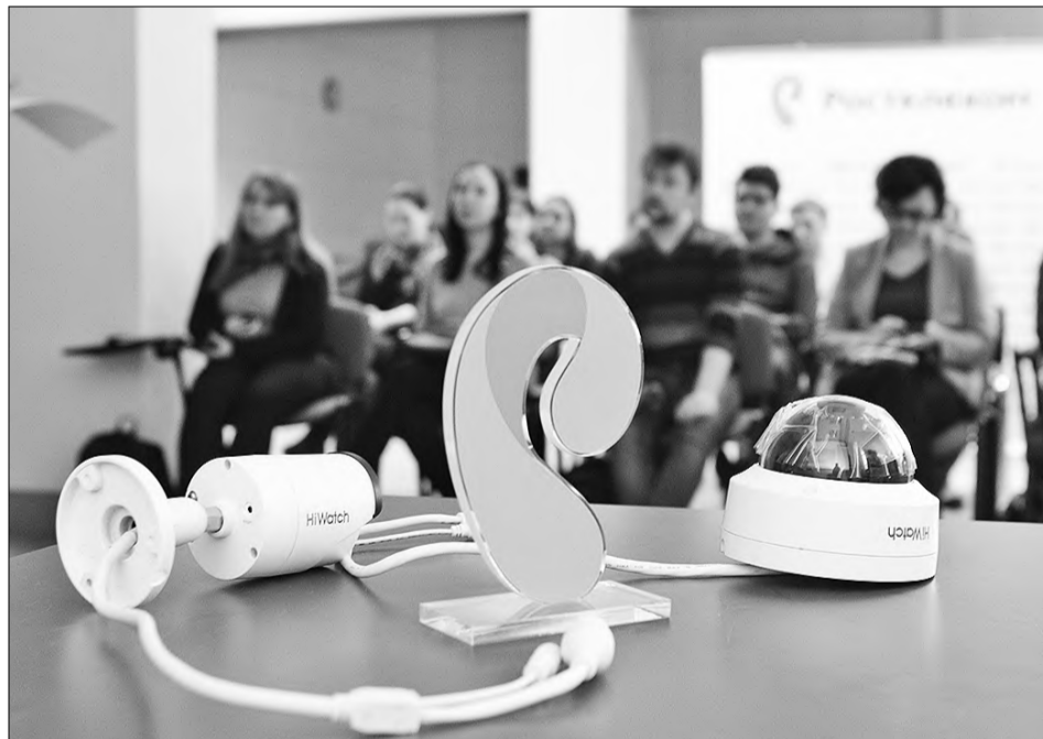
Для осуществления видеонаблюдения компания предлагает на выбор две камеры: цилиндрическую и купольную антивандальную. ФОТО: ТВЕРСКОЙ РЕГИОНАЛЬНЫЙ ФИЛИАЛ ПАО «РОСТЕЛЕКОМ»
